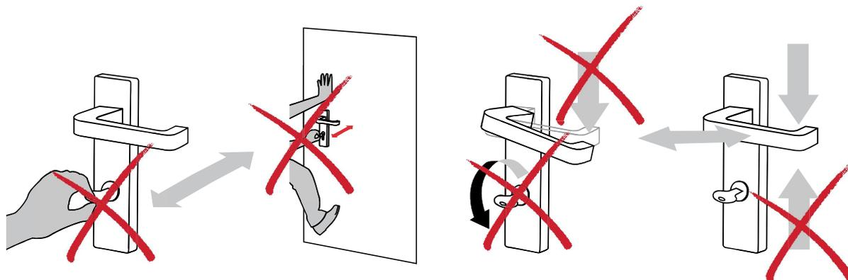
Drücker, Griff, Hebel, Schlüssel nur in die dafür vorgesehene Richtung bewegen. Bewegungen entgegengesetzt der Betätigungsrichtung kann die Elemente zerstören oder beschädigen.
