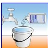
Alle Flächen auf denen (kalkhaltiges) Wasser antrocknet, sollten Sie gelegentlich mit Lithofin KF Sanitärreiniger gründlich reinigen. Zum Schutz zementär gebundener Fugen sollten Sie die Flächen vorher mit Wasser abspritzen und/oder Lithofin KF Sanitärreiniger nur verdünnt einsetzen.
